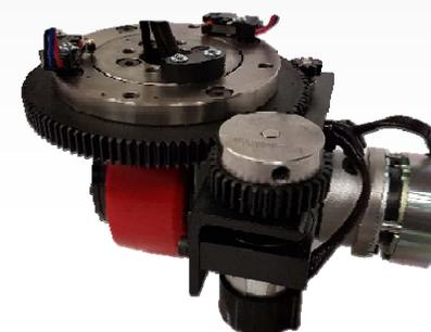
Con un completo portafoglio di motoruote, siamo in grado di coprire ogni richiesta del mercato: a partire dalla neonata orizzontale MIWD 11K-16A, la più compatta della categoria con solo 134mm di altezza da terra, 110mm di diametro ruota, e 250 Kg di portata, alla motoruota verticale più grande SCHABMULLER VD41, con una capacità di carico utile di 4200Kg.
